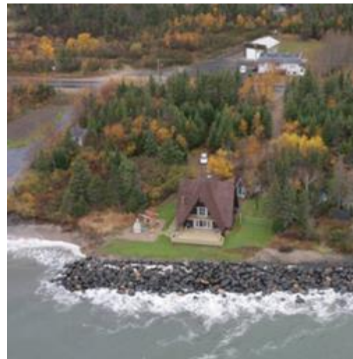
Photo 46 Aggravation de l'érosion de la côte à l'extrémité d'un enrochement (effet de bout) à Sept-Îles dans la région de la Côte Nord (UQAR-LDGIZC)
