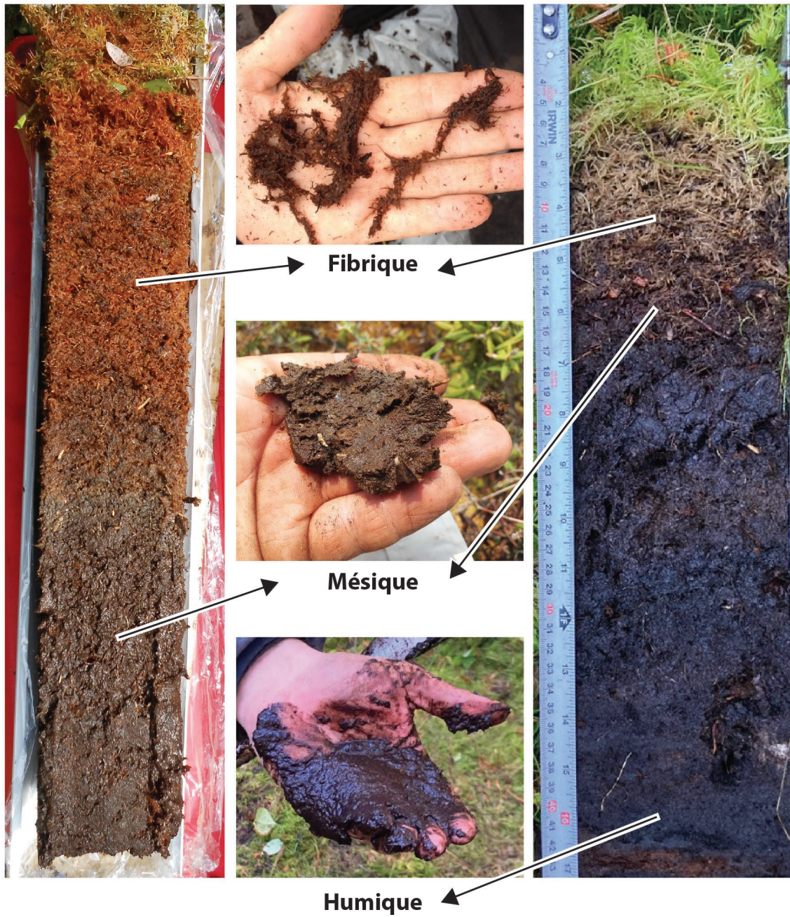
Figure 8. Degrés de décomposition de la matière organique: fibrique, mésique et humique. (Voir l'échelle de von Post à l'annexe 1.)
