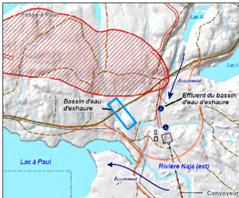
FIGURE 10 : EFFLUENT DU BASSIN D'EAU D'EXHAURE
