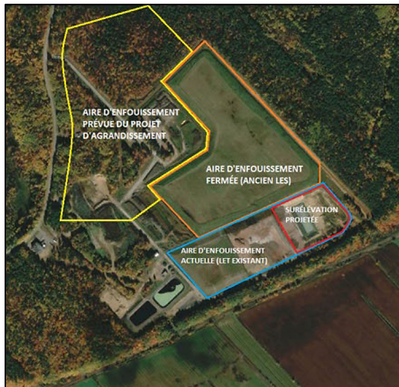
FIGURE 1 AIRE D'ENFOUISSEMENT DU LET DE CHAMPLAIN ET LOCALISATION DE LA SURÉLÉVATION PROJETÉE
