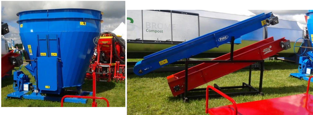
(Source : Pierre-Luc Dessureault) Photographie 6 : Mélangeur et convoyeur qui peuvent être utilisés avec le composteur mécanique
